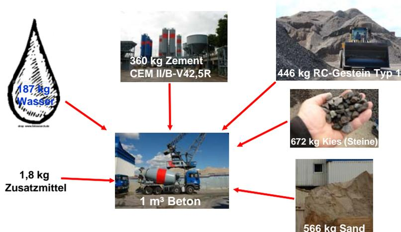
Für das Bauvorhaben Boarding-House der GAG in Ludwigshafen wurde – wie o.a. - allein auf die Rezeptur der Druckfestigkeit C 30/37 zurückgegriffen. Eine Betonrezeptur besteht im Wesentlichen aus Gesteinskörnungen (Kiese / Splitte), Sand sowie Zement
