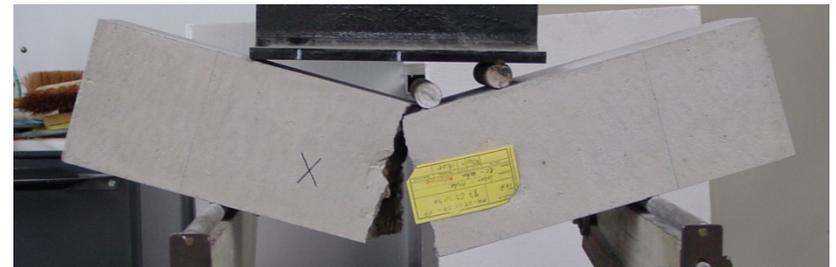
Es erfolgte keine Wasserlagerung der Probekörper (nicht DIN gerecht).
